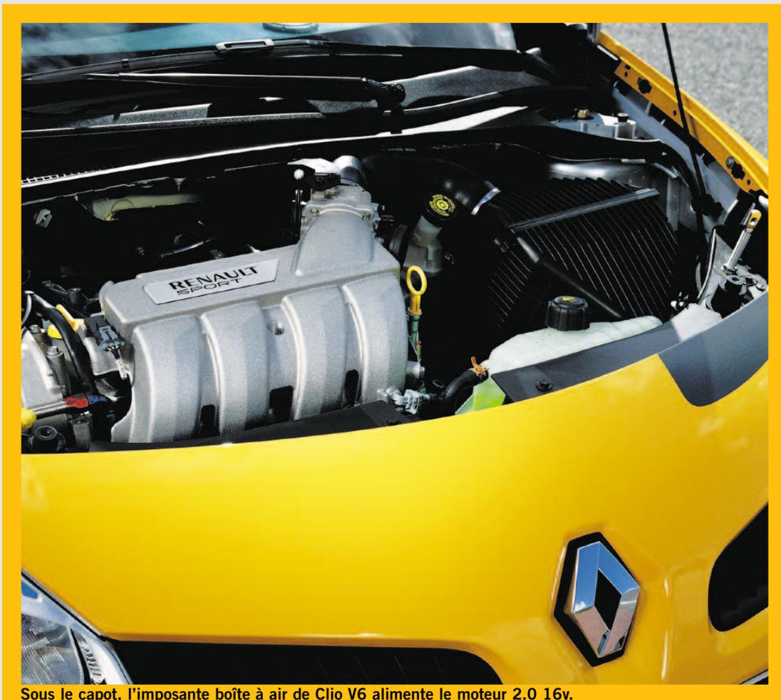
Sous le capot, l'imposante boîte à air de Clio V6 alimente le moteur 2.0 16v.
